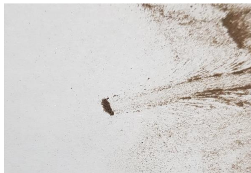
شکل ۵: آهنربای موجود در زیر کاغذ، مواد فرومغناطیسی را جذب می کند و می کشد.
